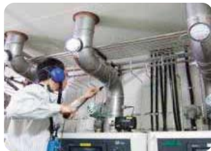
超音波測漏儀 ( ULD ) 量測
